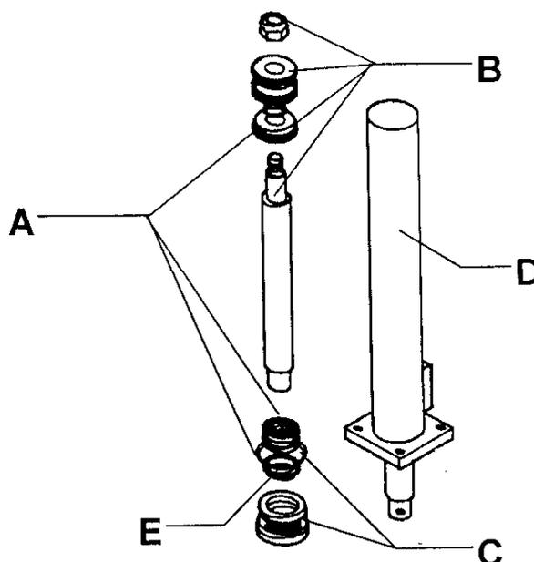
**ESEMPIO : Set completo di guarnizioni per cilindro idraulico COD 0404040015 Richiedere : COD : 0404040015A**
